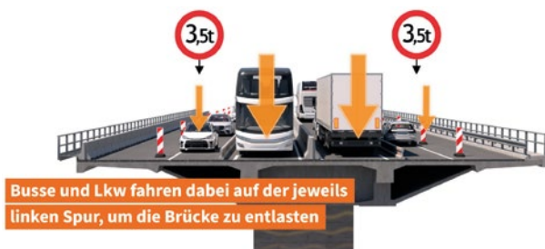
Abb. 1-16: Lueg-Verkehrsführung an Tagen der Zweispurigkeit: Den rechten Fahrstreifen dürfen aus statischen Gründen nur Fahrzeuge unter 3,5 Tonnen befahren. Quelle: ASFiNAG
