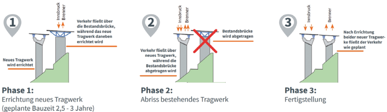
Abb. 1-15: In drei Bauphasen wird die neue Luegbrücke errichtet. Sobald die erste neue Brücke unter Verkehr geht, endet auch die Einspurigkeit. Quelle: ASFiNAG
