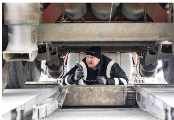
Abb. 1-12: An den Kontrollstellen wird auch der technische Zustand der Fahrzeuge überprüft, da technische Mängel ein großes Sicherheitsrisiko im Straßenverkehr darstellen. Quelle: „Die Fotografen“
