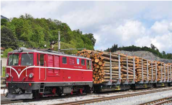
Abb. 3-18: Rundholztransport mit Innofreight-System
