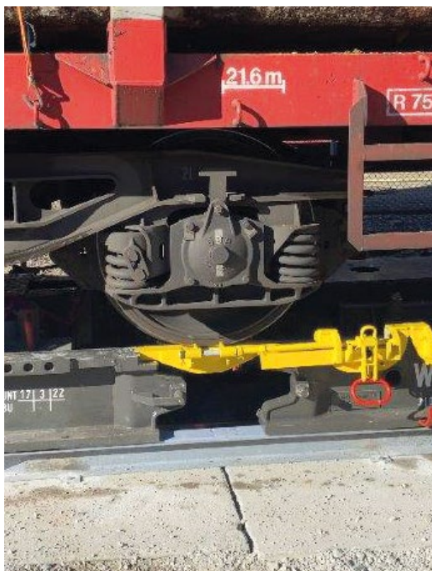
Abb. 3-15 + 3-16: Gleisbrücke zur Verladung von Normalspurwaggons
