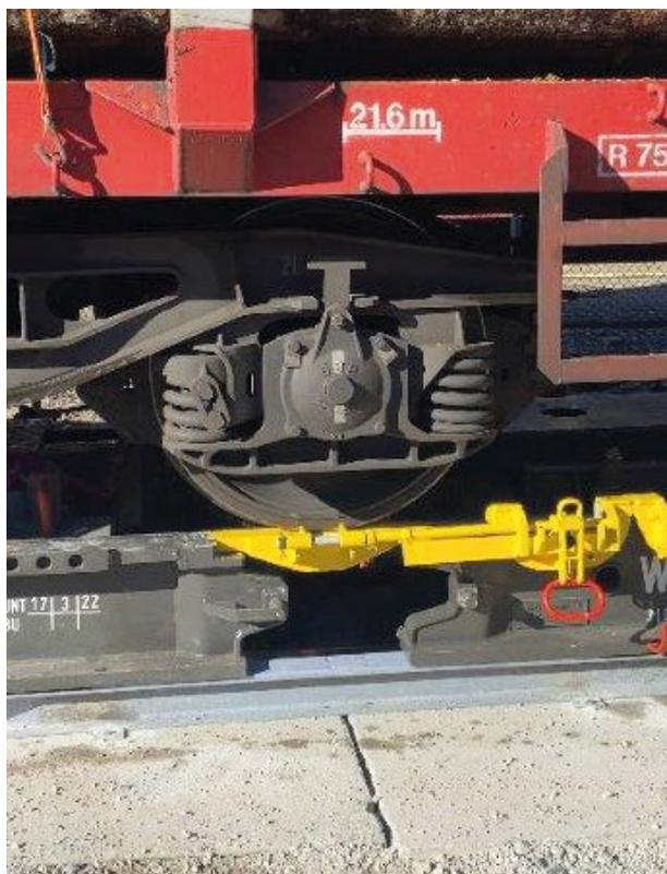
Abb. 3-15 + 3-16: Gleisbrücke zur Verladung von Normalspurwaggons
