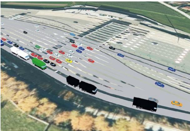
Abb. 1-6: Mikroskopisches Verkehrssimulationsmodell Fahrtrichtung Italien – Mautstelle Schönberg
